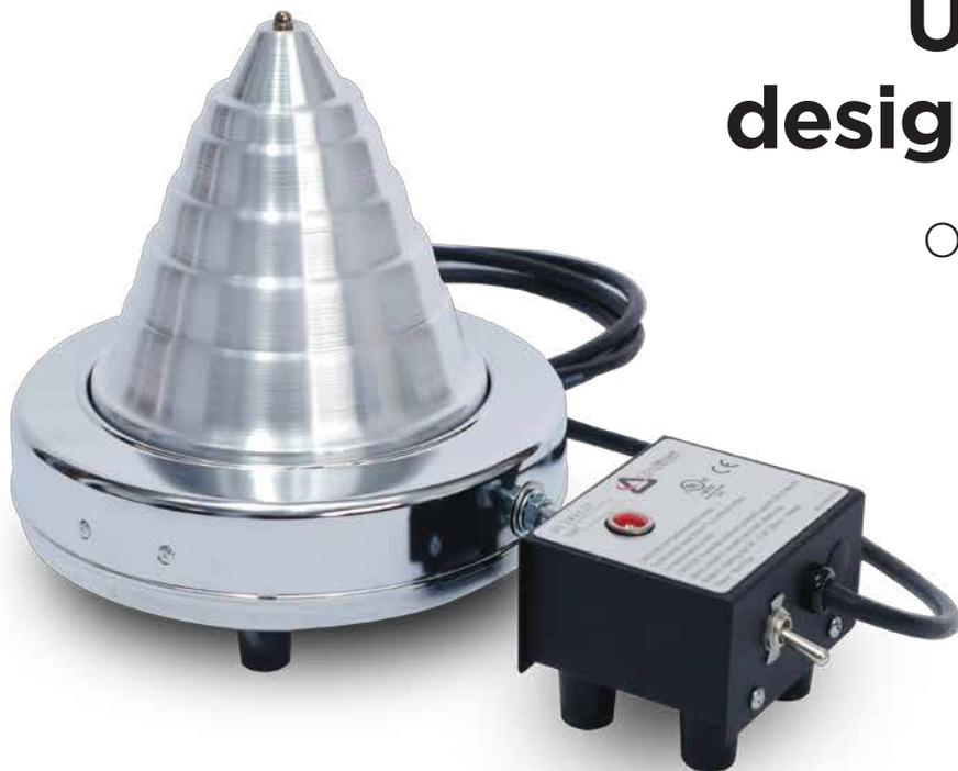
A instalação adequada é essencial para maximizar a vida útil do rolamento. O aquecimento de um rolamento antes da instalação da tampa expande pista interior para permitir o rolamento para ser facilmente montado no eixo. ConeMount Aquecedores de rolamentos pode ajudar a promover a longevidade do rolamento, o que significa menos tempo de inatividade equipamentos e menores custos de manutenção.
