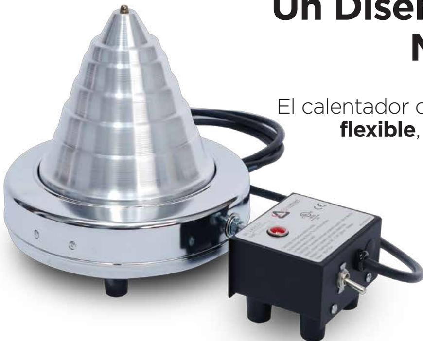
La instalación correcta es esencial para maximizar la vida útil del rodamiento. Calentamiento del cojinete antes de la instalación expande la tapa de la pista interior para permitir que el cojinete se monte fácilmente en el eje. ConeMount Bearing Heaters ayudan a promover longevidad del soporte que significa menos tiempo de inactividad del equipo y bajos costos de mantenimiento.
